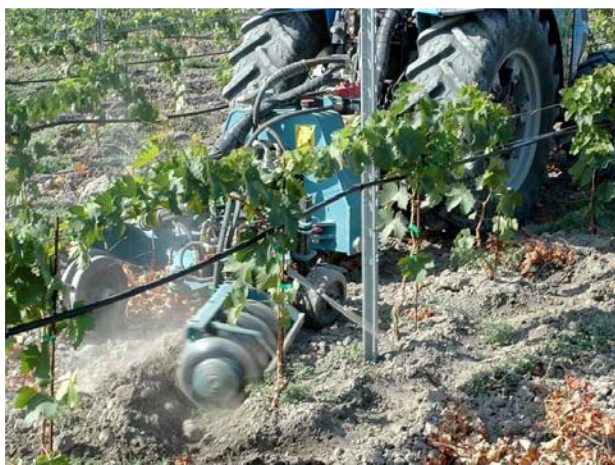
Attrezzature interceppo per la lavorazione sotto la fila nel vigneto.
