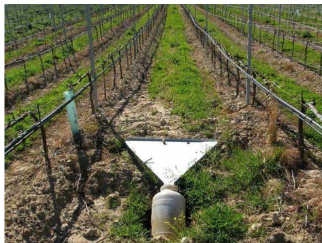
Apparato di misura per la verifica dell’erosione con progetto “GESVE” presso Feudo Arancio (aprile 2006)
