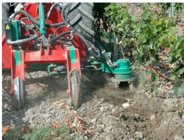
Attrezzature interceppo per la lavorazione sotto la fila nel vigneto.
